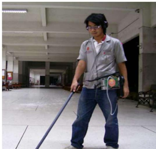
Figure 2.46 L'appareil de navigation attaché à un utilisateur avec un écouteur et une canne à antenne RFID intégrée [65]
