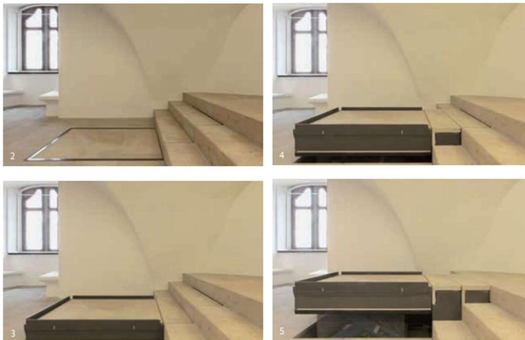
Figure 2.59 Plate-forme de lavage dans un escalier historique en Allemagne [77]
