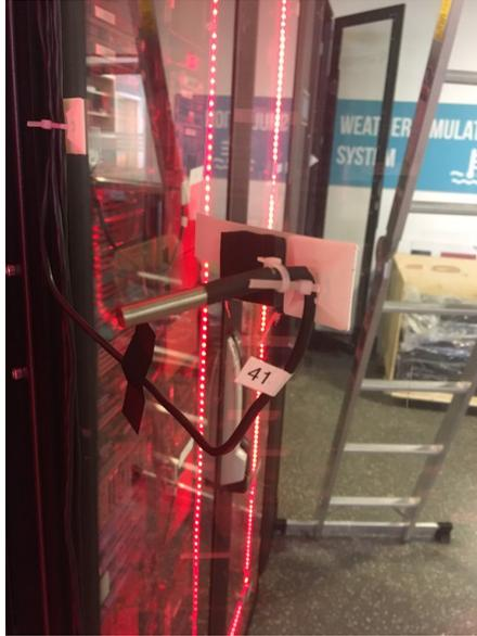
Figure 6.3: DS18B20 digital thermometer
