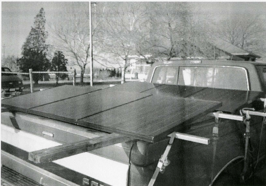
Fig. 6.23 Actual PV Array Setup
