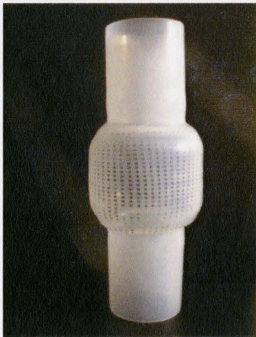
(d) Tube buckling (Case 4)
