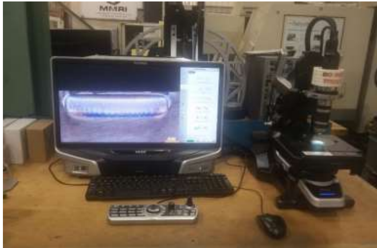
Fig 55) KEYENCE VHX-6000 video microscope
