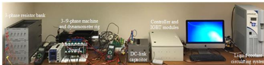
(d) Overview of full experimental setup
