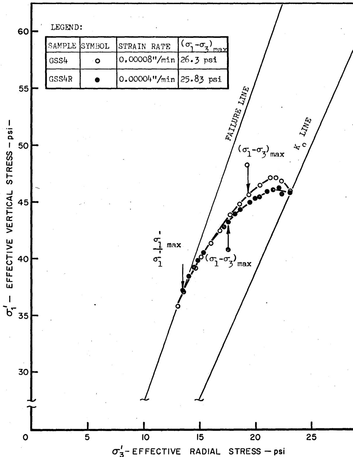
FIG. 26. THE EFFECT OF STRAIN RATE ON THE EFFECTIVE STRESS PATH.
