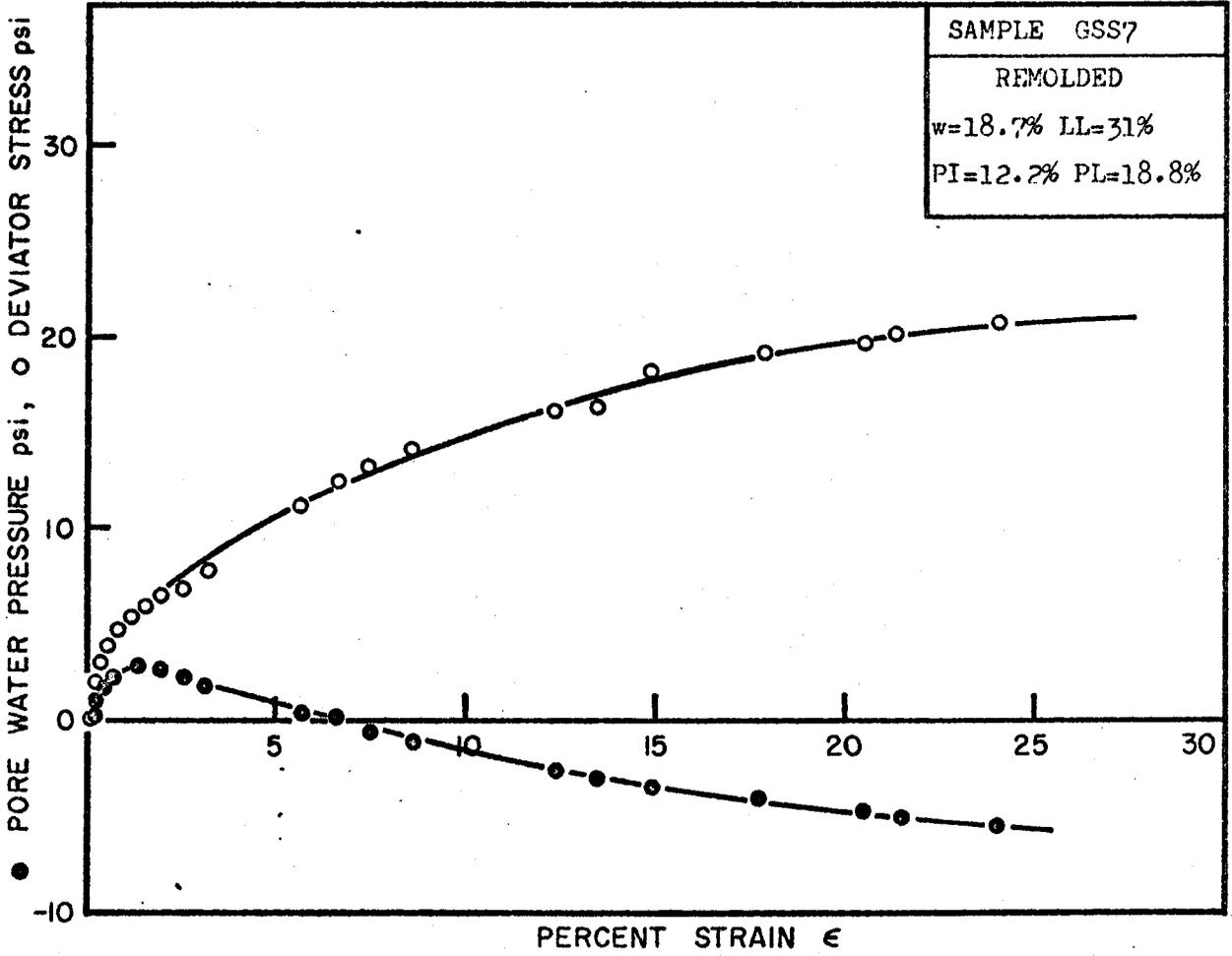
FIG 12 STRESS-STRAIN RELATIONSHIPS-REMOLDED SAMPLES-
