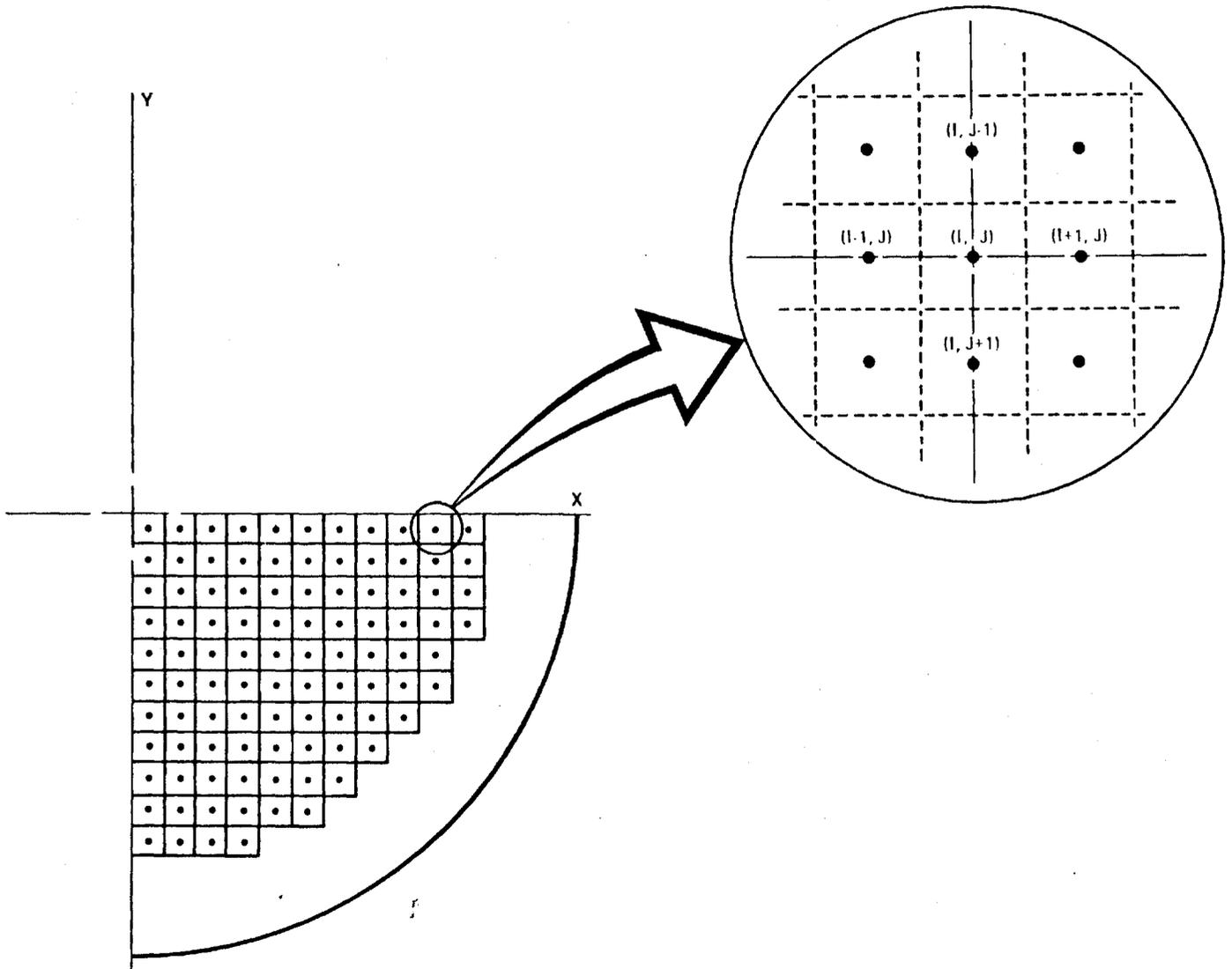
FIGURE 4 GRID REPRESENTATION OF REACTOR
