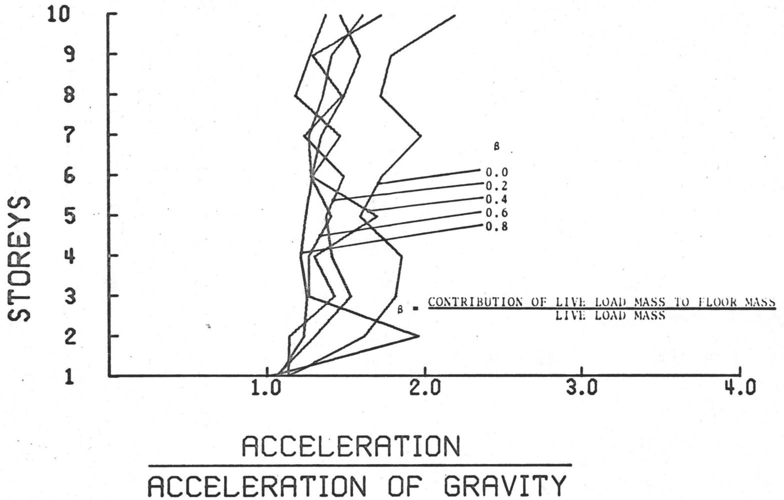
FIG. 4.21 EFFECT OF LIVE LOAD CONTRIBUTION TO FLOOR MASS
