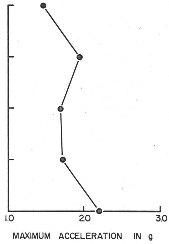
FIG. 4.23 EFFECT OF LIVE LOAD CONTRIBUTION TO FLOOR MASS.
