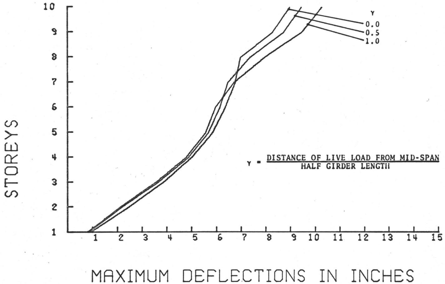
FIG. 4.14 EFFECT OF THE CHANGE OF LIVE LOAD POSITION
