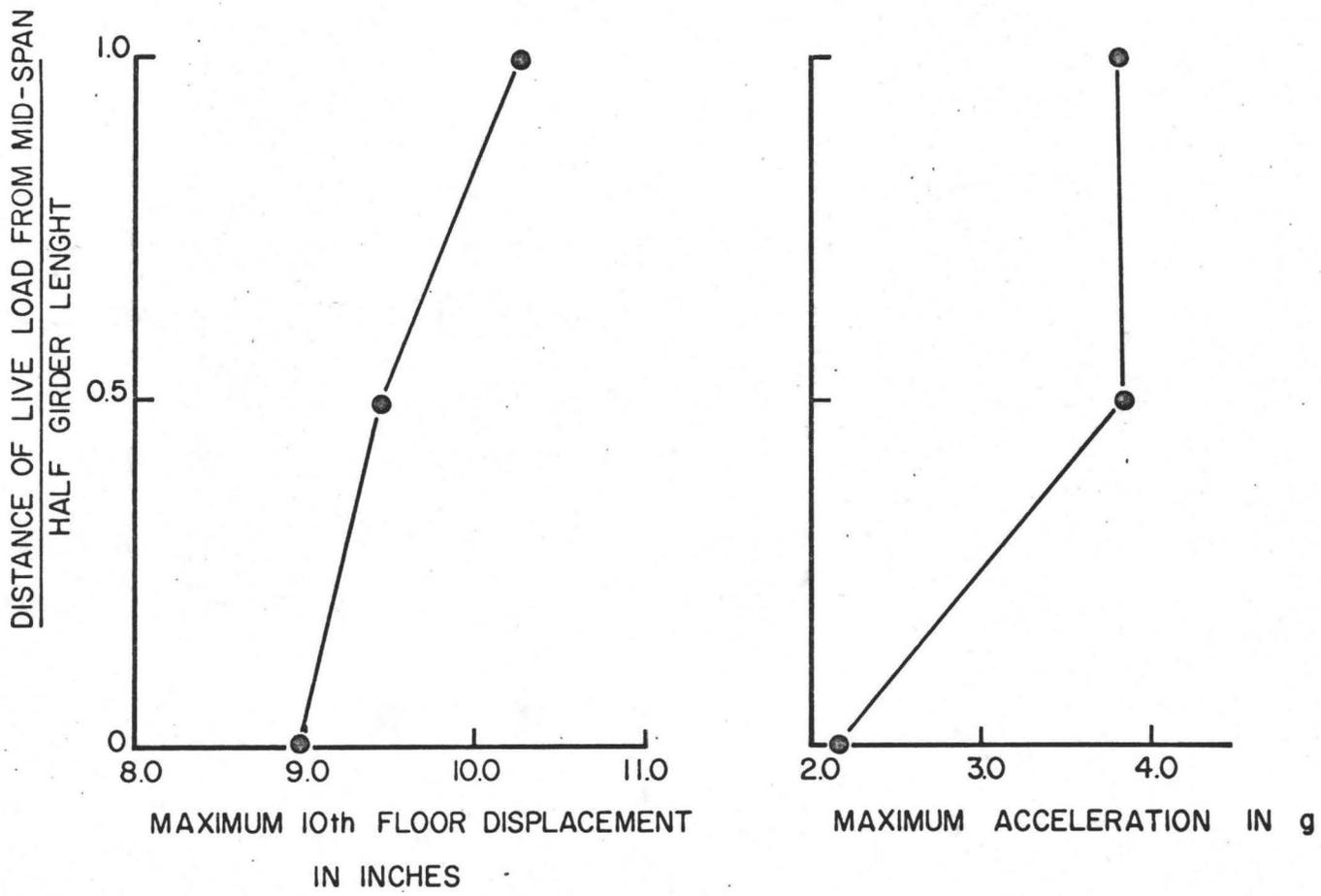
FIG 4.15 EFFECT OF THE CHANGE OF LIVE LOAD POSITION.
