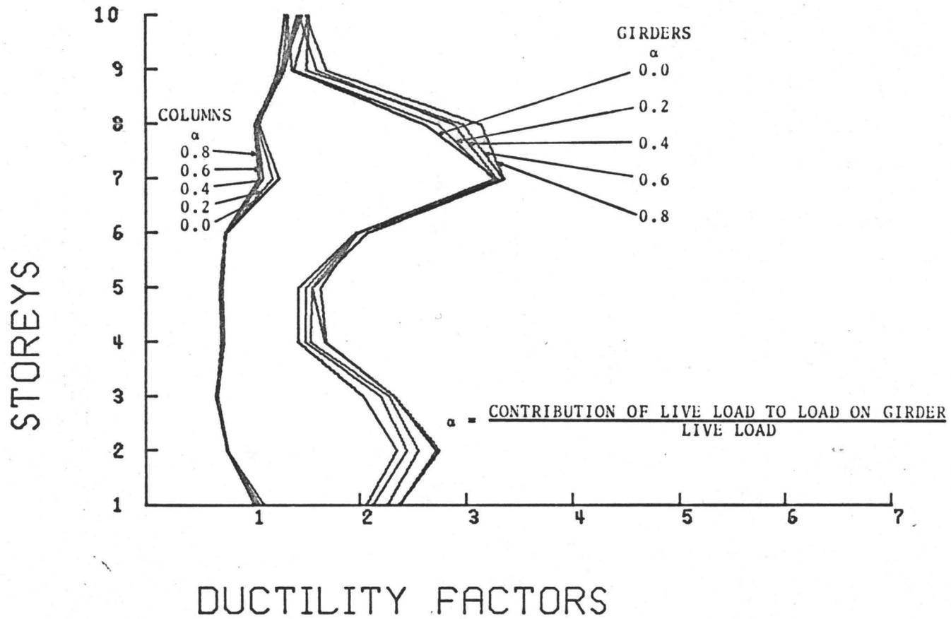
FIG. 4.6 EFFECT OF LIVE LOAD CONTRIBUTION AS A PURE LOAD ON THE GIRDERS
