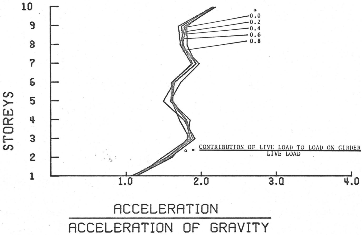
FIG. 4.7 EFFECT OF LIVE LOAD CONTRIBUTION AS A PURE LOAD ON THE GIRDERS
