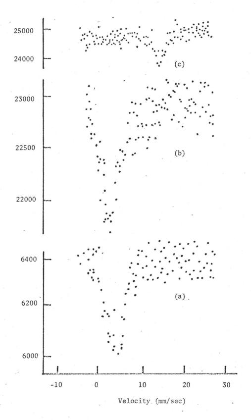
Figure 3. Mössbauer Spectra: (a)  $Sb_2S_3$ , (b)  $Sb_2Te_3$ , (c)  $Na_3SbS_4 \cdot 9H_2O$
